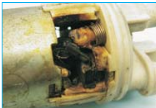
Poškození v důsledku chodu nasucho
